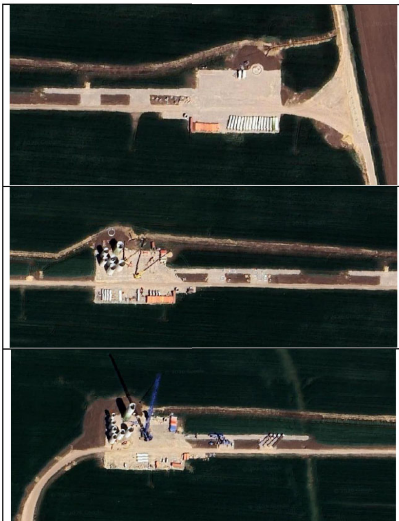
Фигура 1.6.1-2 Изображения на монтажни площадки по време на строителство на различни етапи след засипване на фундамента.
