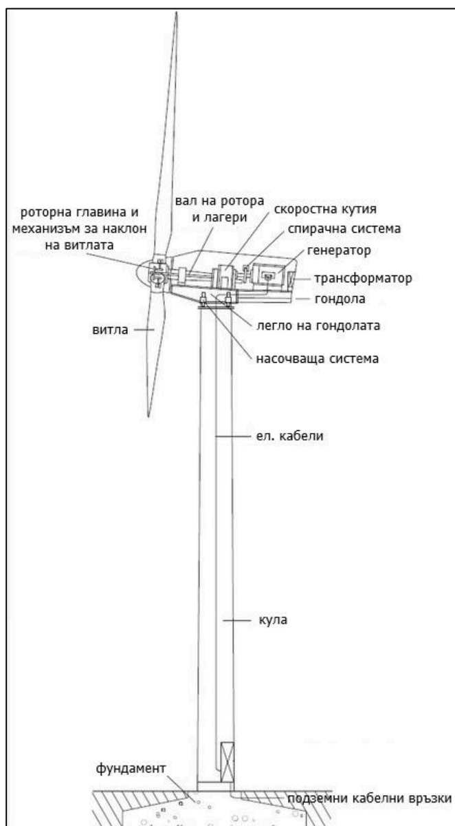
Фигура 3 Индикативна схема на компонентите на вятърна турбина
